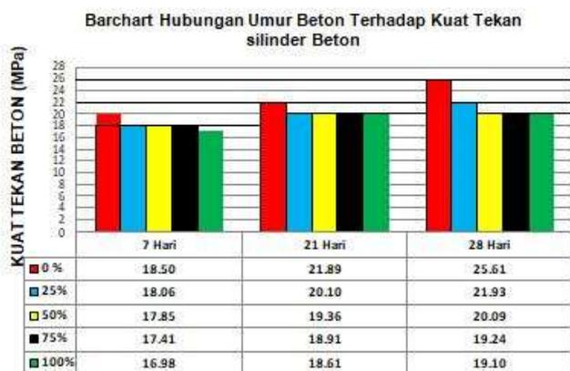
Gambar 10. Barchart Hubungan Umur Beton Terhadap Kuat Tekan silinder Beton
