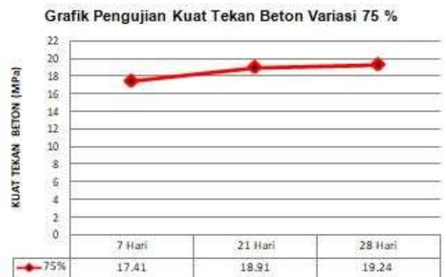
Gambar 8. Grafik Pengujian Kuat Tekan Beton Variasi 75 %
