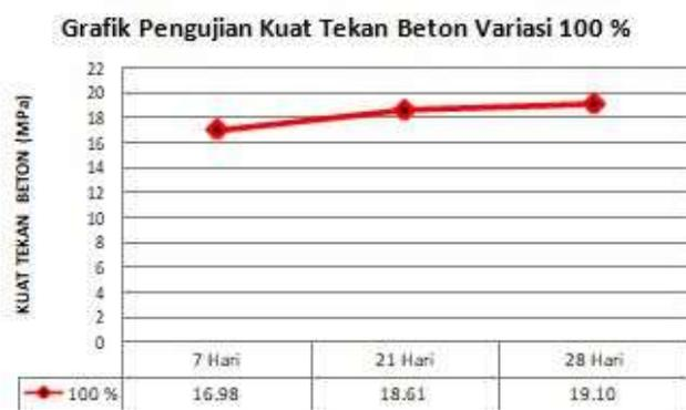
Gambar 9. Grafik Pengujian Kuat Tekan Beton Variasi 100 %
