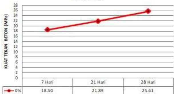
Gambar 5. Hasil Pengujian Kuat Tekan Beton Normal (Variasi 0 %)
