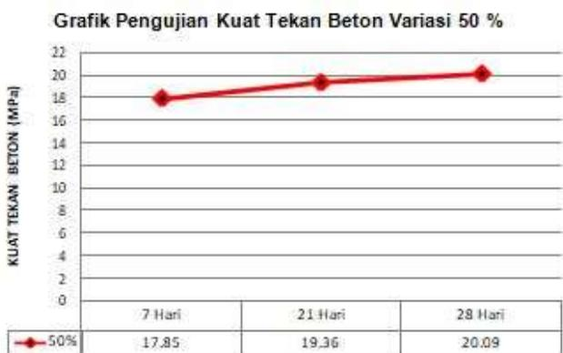
Gambar 7. Grafik Pengujian Kuat Tekan Beton Variasi 50 %
