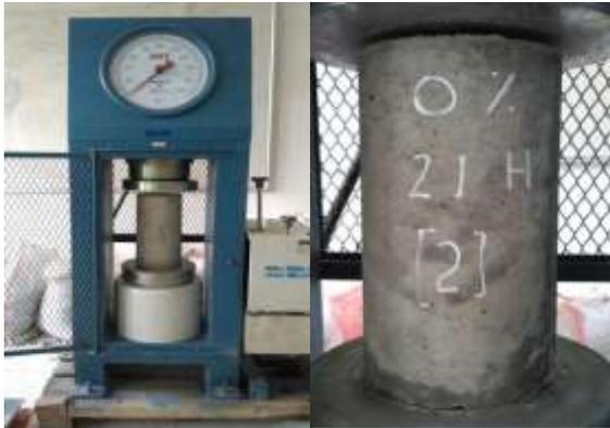
Gambar 3. Pengujian Kuat Tekan dengan MBT Machine Testing
